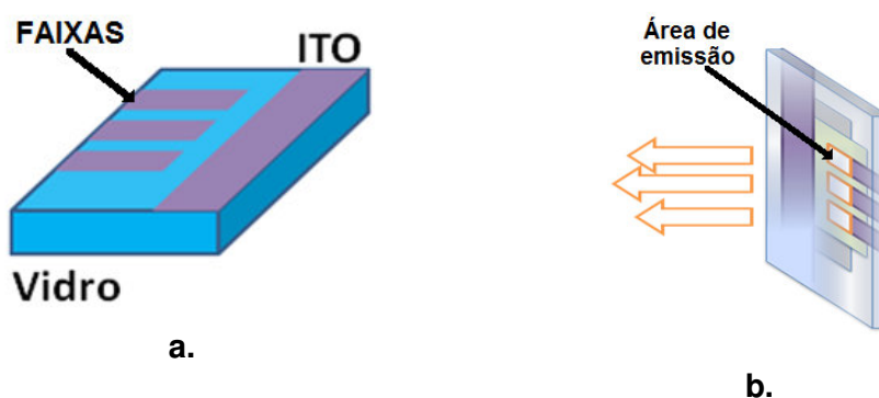
Figura 3.6 a. Substratos de vidro recoberto com camada de ITO e b. Representação das áreas ativas dos OLEDs fabricados.
