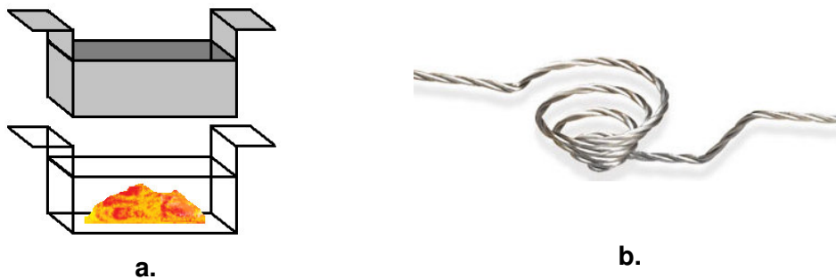
Figura 3.8 a. Ilustração dos cadinhos usados para a evaporação dos materiais orgânicos. Em b. Figura do cadinho (basket) de Tungstênio usado para deposição de Al.
